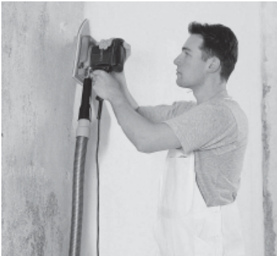
Absaugen von Staub bei der Arbeit mit Elektrowerkzeug, gesteuert durch die Einschaltautomatik. Automatischer Anlauf des Saugers beim Start des Elektrogerätes. (Best.-Nr. 58 405 1)
